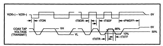
**FIGURE 2 : Transmit Function**
